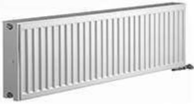
Четырехэтапная антикоррозийная обработка: глубокое обезжиривание, фосфатирование, грунтовка, горячее порошковое распыление. Имеет верхнюю решетку съемного типа. Изготовлен с помощью высокочастотной сварки. Травмобезопасные края. Гигиенический, т.е. рассчитан для помещений с санитарно-гигиеническими нормами и правилами. Приборы устанавливаются любой стороной, т.к. отсутствуют планки, определяющие заднюю сторону. Эксплуатационная надежность. Высокая степень экологичности.
