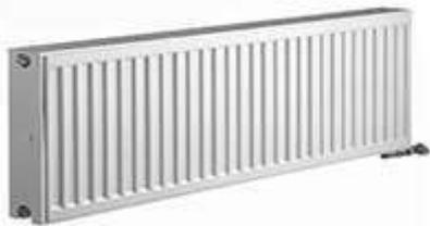
Четырехэтапная антикоррозийная обработка: глубокое обезжиривание, фосфатирование, грунтовка, горячее порошковое распыление. Имеет верхнюю решетку съемного типа. Изготовлен с помощью высокочастотной сварки. Травмобезопасные края. Гигиенический, т.е. рассчитан для помещений с санитарно-гигиеническими нормами и правилами. Приборы устанавливаются любой стороной, т.к. отсутствуют планки, определяющие заднюю сторону. Эксплуатационная надежность. Высокая степень экологичности
